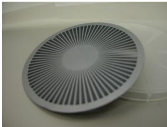
図 2: 4 インチ基板にドライエッチングで製作され、曲率半径 1 m に高温塑性変形された Si 光学系。
